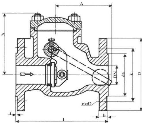
Rückschlaghebel mit Hebel und Gewicht aus GJL-250/X12Cr13
