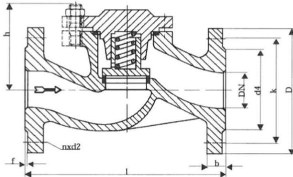
Rückschlagventil mit Feder aus GP240GH+N
